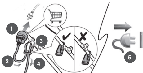
Рис. 8 Фиксация кабеля удлинителя на рабочей рукоятке.
